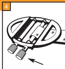
Monteren van de lintverbinder 20mm/40mm
